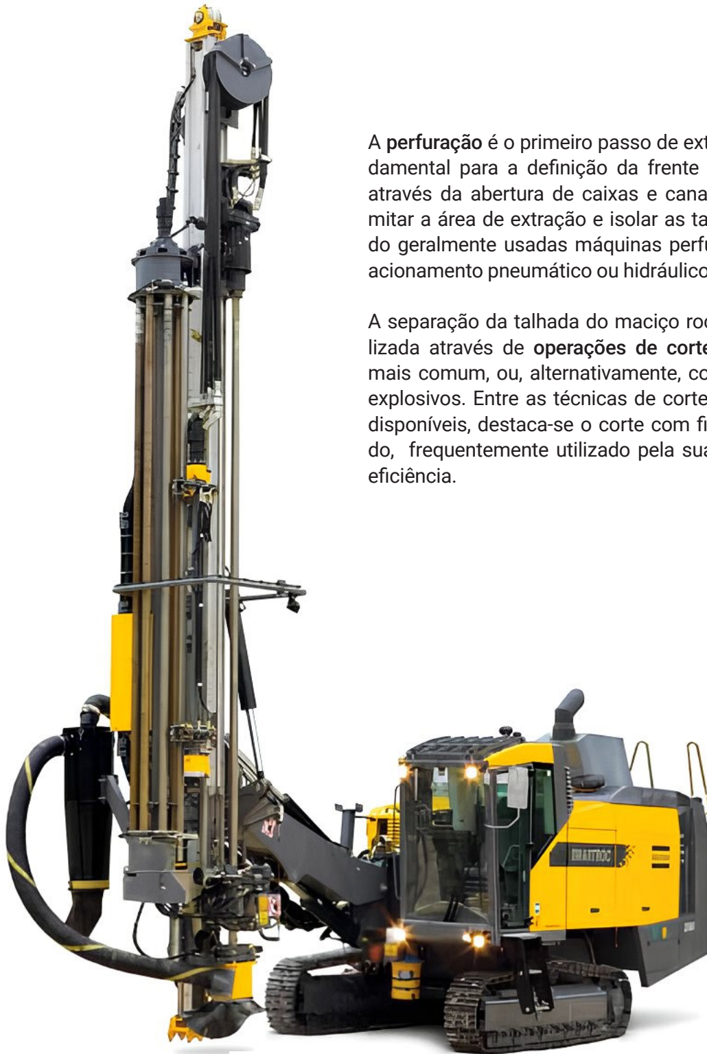
► Figura 1.7. Máquina perfuradora para efetuar furos verticais ou horizontais na bancada, ou furos numa talhada para a realização de blocos (Fonte: Epiroc [4]).
