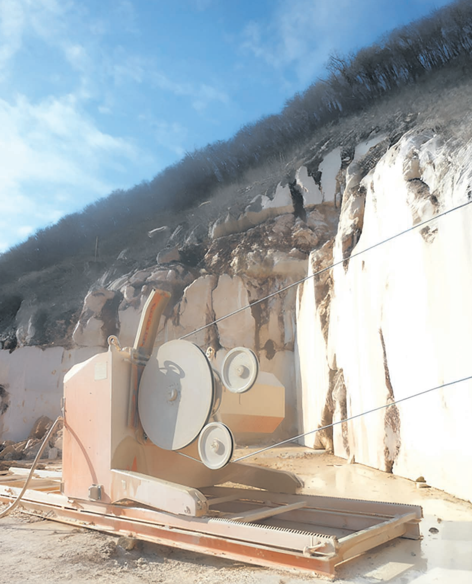
► Figura 1.8. Máquina de corte com fio diamantado para extração de granito [5].
