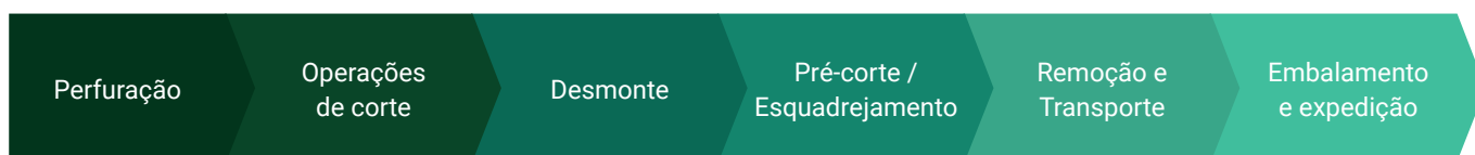
► Figura 1.6. Diagrama simplificado da fase de extração de pedra natural.
